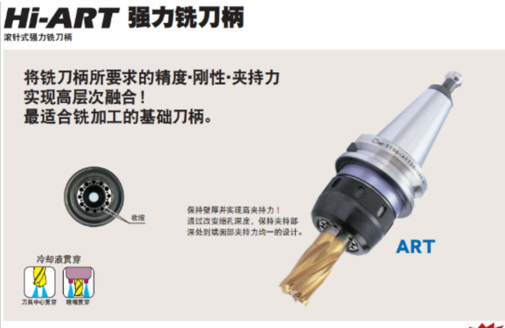
目前市面上大多强力铣刀柄厂家都采用旋转外圈螺母使刀柄内壁收缩的锁紧方式。由于内壁需要收缩夹持刃具柄部，壁厚过大则容易造成收缩量不够，夹持力达不到要求，壁厚过薄，则刀柄的横向刚性不足。因此，这就需要在保证合适的内壁厚度的情况下，也能保证其内壁的收缩量。实际加工中多使用公差范围内的刃具或者直筒夹套，而夹持力也是在刀柄内径和直筒夹套之间的间隙为0以及直筒夹套内径和立铣刀柄部的间隙为0时开始产生，因此，刀柄内径的收缩量至少需要有0.1mm-0.12mm以上的余量。不然，其样本给出的值则有待商榷。如果减小刀柄和刃具之间的间隙，则造成立铣刀装夹困难，操作不便。所以，收缩量对日常作业有很大影响。
